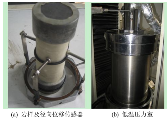
图 1 试样安装及低温压力室
